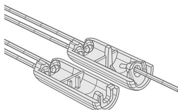
Fissateli nel canale centrale di una metà della clip. Se questa si discosta leggermente dalla figura, non preoccupatevi, basta inserire i cordini che non sono già legati all'interno nello stesso modo.
