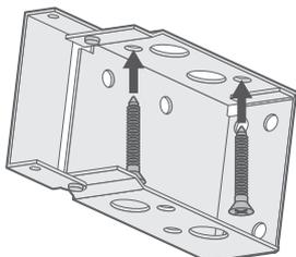
Le staffe vengono avvitate sull'architrave (parte superiore del vano finestra)
