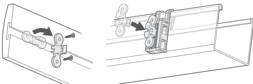
Fissate le clip ad alette alla parte posteriore della mantovana e fissate le clip seghettate sul supporto (se state montando la tenda interno nicchia, questo andrebbe fatto prima dello step 2), controllate che le posizioni delle due clip combacino. A questo punto allineate le due clip e unitele con una leggera pressione sulla parte frontale della mantovana.
