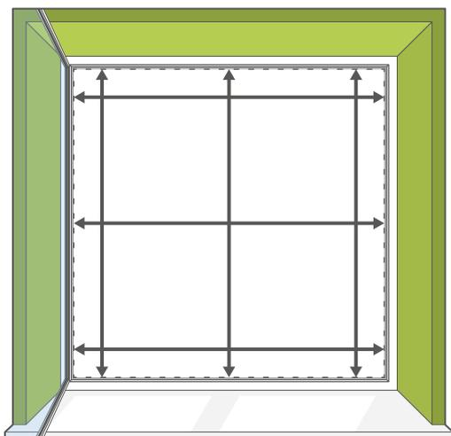
Misurate l'interno del telaio della finestra, prendendo le misure in tre punti diversi sia per la larghezza che per l'altezza. Considerate sempre la misura più piccola.
