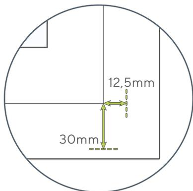
Prima di iniziare, assicuratevi di avere spazio sufficiente sul telaio esterno per installare correttamente la zanzariera. Sono necessari almeno 30 mm nella parte superiore e inferiore e almeno 12,5 mm sui lati destro e sinistro.
