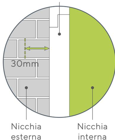
Assicuratevi di misurare la nicchia nel punto esatto in cui installerete la zanzariera, che deve essere ad almeno 30 mm di distanza dal telaio della finestra.
