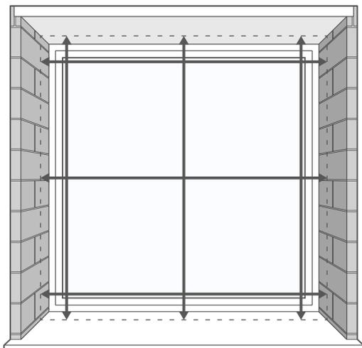
Vi ricordiamo che le nostre zanzariere a rullo sono adatte solo per installazioni in incasso. Per le misurazioni, utilizzate sempre un metro a nastro in metallo, poiché quelli in plastica o tessuto potrebbero allungarsi e dare misure imprecise.
