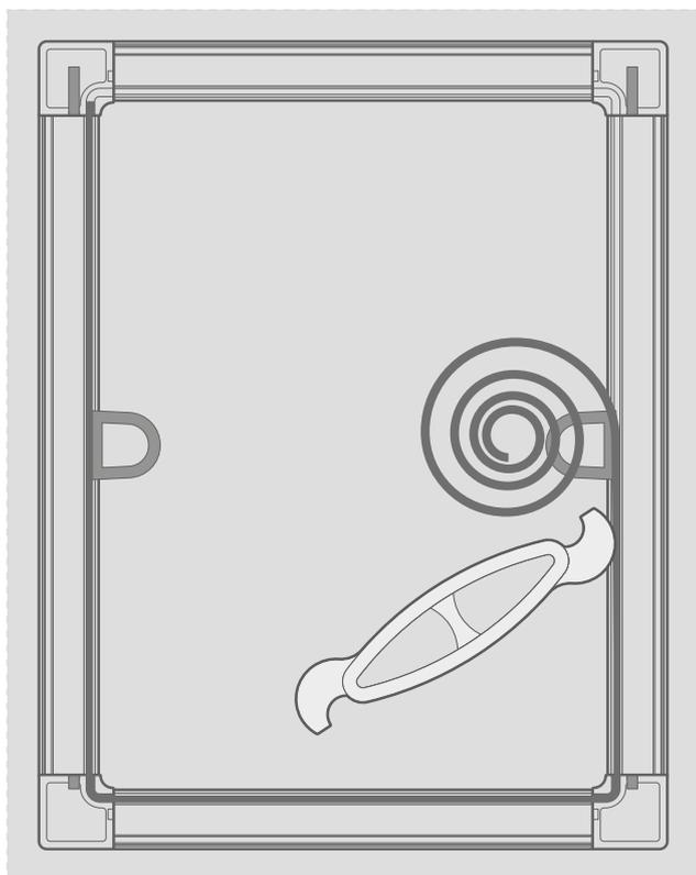
Utilizzate l'utensile di pressatura in dotazione per spingere la guarnizione in gomma nel canale interno, sigillando la rete in posizione. La guarnizione dovrebbe premere dietro le maniglie, bloccandole in posizione.
