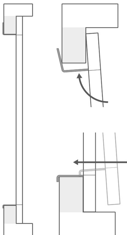
Posizionate il telaio verso la finestra. Agganciate i supporti più lunghi (nella parte superiore della zanzariera) al telaio esterno.
