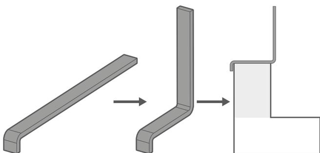
Successivamente, utilizzate gli strumenti di flessione per piegare ad angolo retto i ganci di montaggio.
