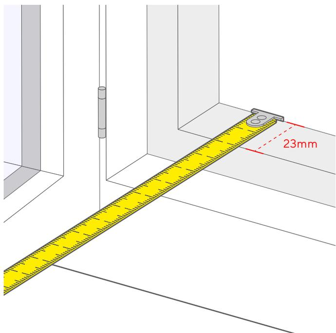
Misurate la profondità (lo spessore) del telaio esterno.
