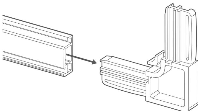
Incastrate gli angoli di giunzione alle estremità del telaio superiore e inferiore.
