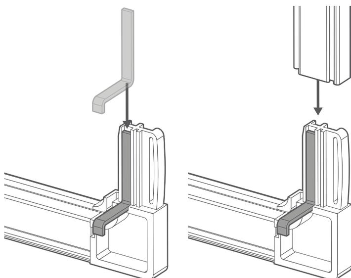
Posizionate i ganci di montaggio piegati nei canali verticali degli angoli di giunzione prima di incastrarli nei telai laterali.
