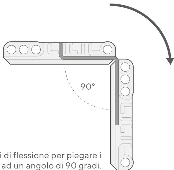
Utilizzate gli strumenti di flessione per piegare i ganci di montaggio ad un angolo di 90 gradi.
