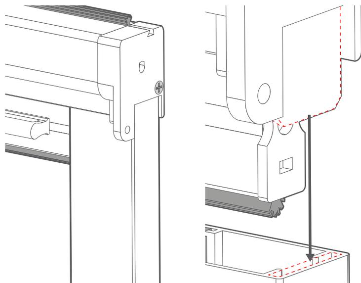
Incastrate i telai laterali alle estremità del cassetto, assicurandovi un corretto allineamento grazie alla fessura presente nella parte superiore di ciascun telaio.
