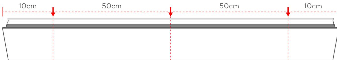
Forate i telai laterali per fissarli, iniziando con un primo foro a 10 cm da ciascuna estremità. Successivamente, praticate altri fori ogni 50 cm circa. Le distanze non devono essere esatte, ma è fondamentale distribuirle in modo uniforme lungo l'intera lunghezza dei telai.
