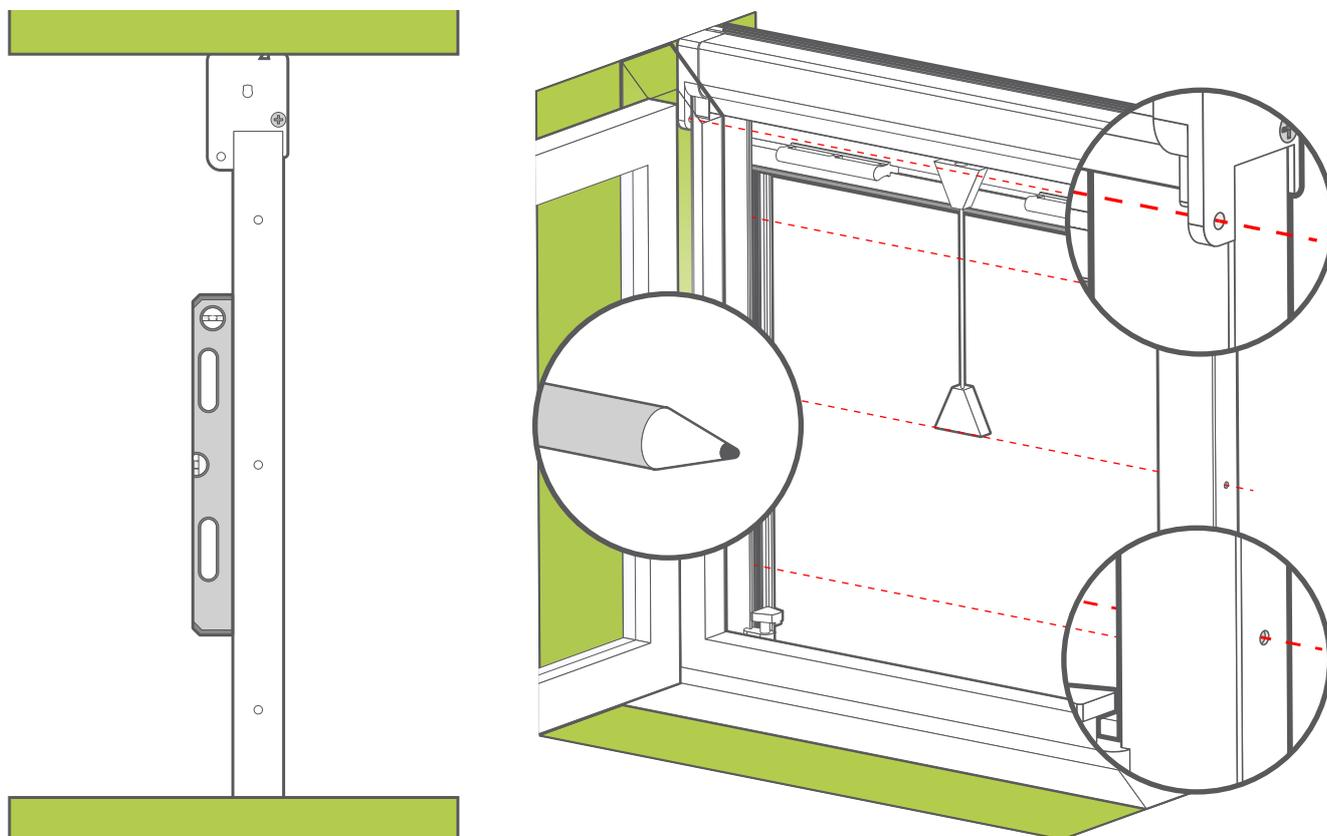
Posizionate la zanzariera nella nicchia e utilizzate una livella a bolla per assicurarvi che sia perfettamente dritta. Una volta allineata, segnate con una matita i punti in cui eseguire i fori.
