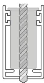
Inserite l'utensile di protezione del trapano nel telaio, allineando il centro del foro più piccolo al punto in cui desiderate forare. Prima di iniziare, fate passare la punta del trapano attraverso l'utensile di protezione: questo accorgimento aiuterà a evitare danni alle spazzole nei telai laterali.
