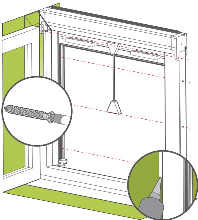
Riposizionate la zanzariera, verificando con una livella a bolla che sia perfettamente dritta, quindi fissatela avvitandola in posizione.
