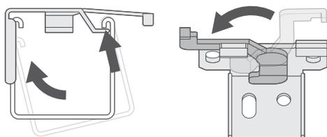
Agganciate il bordino anteriore del finecorsa ai ganci della parte anteriore della staffa, quindi sollevatene il retro in modo che siano sullo stesso livello. Tenendolo in questa posizione, fate girare il pezzo oscillante e premetelo saldamente contro il finecorsa per bloccarlo in posizione.
