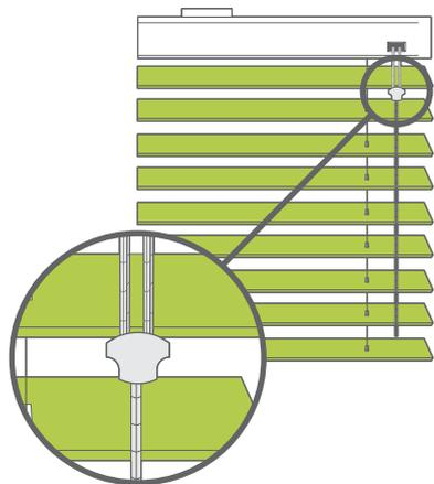
I cordini sono premontati su una clip per rendere più sicuro il loro movimento. In caso di urto su di essi la clip si romperà rilasciandoli ed evitando che si attorciglino in maniera pericolosa per i bambini.
