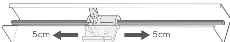
Installate le altre staffe uniformemente lungo la larghezza della tenda, evitando che interferiscano con altri componenti del binario.
