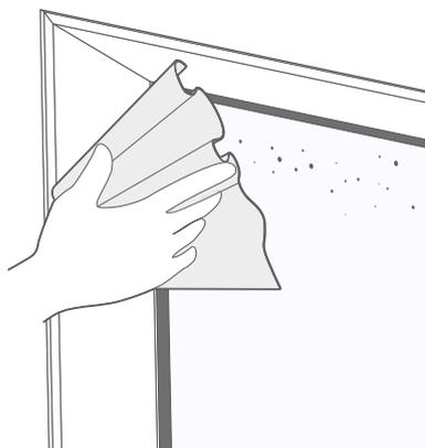
Prima dell'installazione, è importante preparare adeguatamente la superficie: pulite a fondo la finestra, concentrandovi in particolare sulle aree superiore e inferiore dove la tenda verrà fissata. Assicuratevi che il vetro sia completamente asciutto prima di procedere. Per agevolare questa operazione, all'interno della confezione troverete salviette sigillate con alcool, fornite appositamente per la pulizia preliminare.
