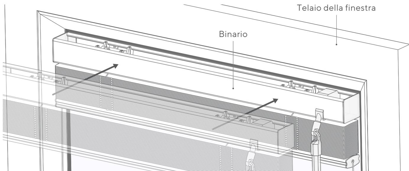
Allineate con attenzione il binario superiore con la parte superiore del vetro. Assicuratevi che la parte superiore del binario sia a filo con il bordo della guarnizione in gomma, se visibile, oppure con il bordo del telaio, se la guarnizione non è presente. Premete la parte adesiva contro il vetro e mantenete la pressione finché non risulta ben fissata.
