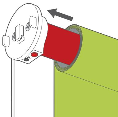
Se non avete una presa di corrente vicina alla tenda, potete semplicemente sfilare il motore e metterlo poi a ricaricare.
