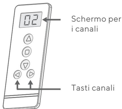
Il telecomando sarà già programmato durante la produzione per interagire con la vostra tenda, non sarà necessaria nessuna programmazione iniziale (l'impostazione di posizione intermedia invece è opzionale). Nel caso l'ordine comprenda più tende motorizzate, ogni tenda verrà programmata su un diverso canale il quale verrà indicato sul retro della parte inferiore di ciascuna tenda.
