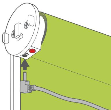
Per caricare la batteria inserite il cavo di caricamento nella presa di ricarica del motore.
