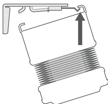
Posizionate il bordo anteriore del finecorsa sulla parte anteriore della staffa.
