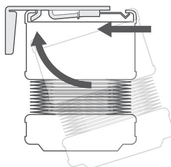
Successivamente ruotate il retro del finecorsa verso l'alto fino a quando non si aggancia alla parte posteriore della staffa.
