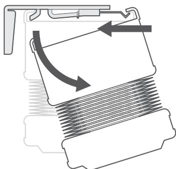
Per rimuovere la tenda dalle staffe dopo l'installazione, spingete con decisione il finecorsa e contemporaneamente ruotatelo verso il basso per sganciarlo dalla staffa, come rappresentato in figura.
