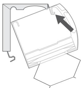
Posizionate il bordo anteriore del finecorsa sul gancio anteriore della staffa.
