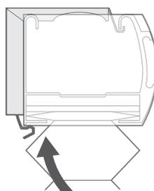
Successivamente ruotate il retro del finecorsa verso l'alto finché non si aggancia alla clip metallica della staffa.
