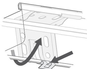
Per rimuovere la tenda dalle staffe, inserite un cacciavite a testa piatta nella linguetta che sporge dalla parte inferiore del finecorsa, fate leva mentre la parte posteriore del finecorsa si inclina verso il basso. Ripetete questa operazione con attenzione per ogni staffa.
