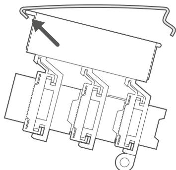
Appoggiate il finecorsa nella parte anteriore della staffa
