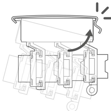
Successivamente ruotate il retro del finecorsa verso l'alto fino a quando scatterà in posizione sulla parte posteriore come mostrato in figura.
