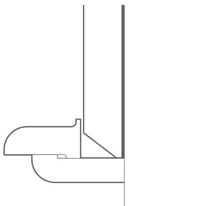
La tenda è dotata guide laterali in acciaio che la tengono saldamente fissata alla finestra, passando attraverso le lamelle.
