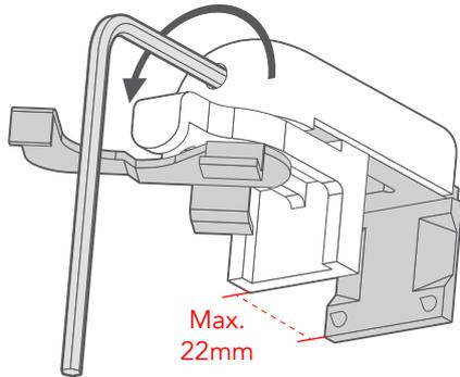
Utilizzate la chiave a brugola per allentare la staffa e apritela fino a un massimo di 22mm.
