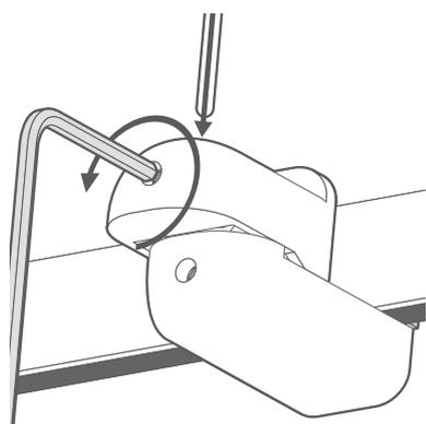
Usate la chiave a brugola per allentare la parte superiore della staffa in modo da poter inserire il cavo.
