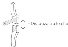
Utilizzate le viti in dotazione per fissare le clip di sicurezza alla parete.
