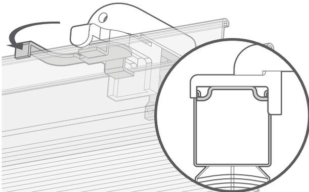
Assicuratevi che il braccetto girevole sulla parte anteriore della staffa sia rivolto in avanti. Incastrate la parte posteriore del binario sul gancio posteriore del braccetto girevole. Sollevate la parte anteriore del binario fino a portarla in piano. Infine premete il braccetto girevole contro il binario per fissarlo.
