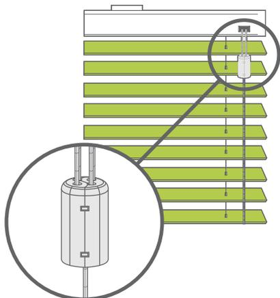
I cordini sono premontati su una clip per rendere più sicuro il loro movimento. In caso di urto su di essi la clip si romperà rilasciandoli ed evitando che si attorciglino in maniera pericolosa per i bambini.
