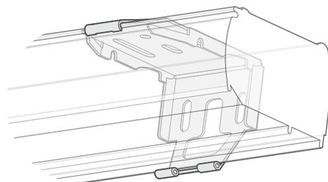
Tenendo il finecorsa ad angolo con il retro verso il basso, posizionate la linguetta anteriore nel gancio della staffa. Quindi, spingete verso l'alto fino a quando il finecorsa non si aggancerà correttamente.
