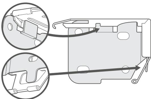
Inserite il componente d'installazione laterale all'interno della staffa come mostrato in figura, quindi utilizzate i pezzi in dotazione per fissarli insieme.
