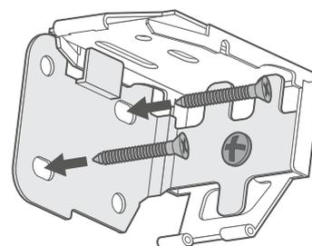
Utilizzate i fori nel componente di montaggio laterale per avvitarlo nel vano finestra.
