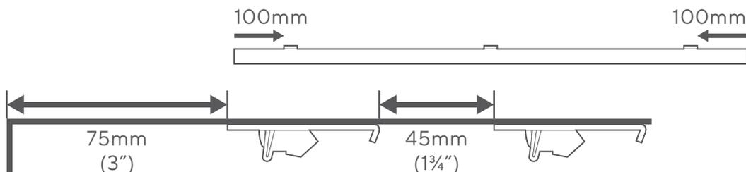
Scegliendo l'installazione a soffitto, le staffe andranno posizionate in modo che la parte retrostante della staffa posteriore sia ad almeno 75 mm di distanza dal telaio della finestra. Dovreste quindi avere almeno 45 mm tra la staffa posteriore e la staffa anteriore, spazio necessario per le pieghe del tessuto in entrambe le tende.
