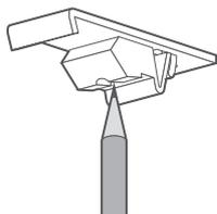
Rimuovete la vite di bloccaggio da ogni staffa e tenete le staffe nella posizione desiderata, utilizzando una matita per segnare dove andrà la vite.
