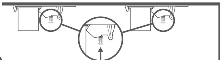
Allineate le viti di bloccaggio delle staffe con i fori, successivamente stringete le viti in ciascuna staffa.
