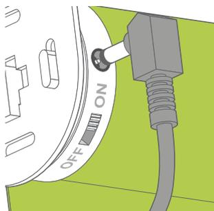
Una volta installata la tenda, vi consigliamo di caricarla completamente prima dell'uso. Collegate il cavo di ricarica (incluso) come in figura e caricate fino a quando il LED sulla spina del caricatore diventa verde.
