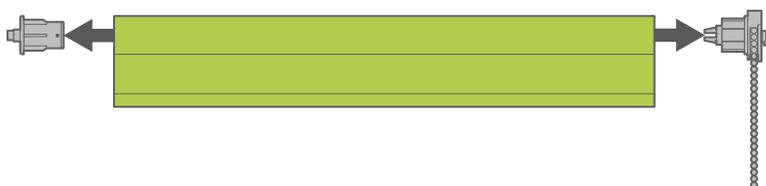
Troverete l'elemento di controllo sul lato da voi indicato in fase d'ordine. In caso abbiate cambiato idea, potrete spostarlo sul lato opposto semplicemente disinserendolo dal tubo. Questo passaggio va eseguito prima di installare le staffe.
