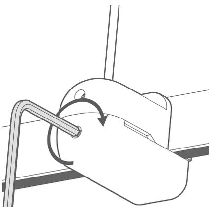
Una volta soddisfatti della posizione delle staffe, stringete la parte inferiore di ciascuna di esse per fissarla alla finestra.
