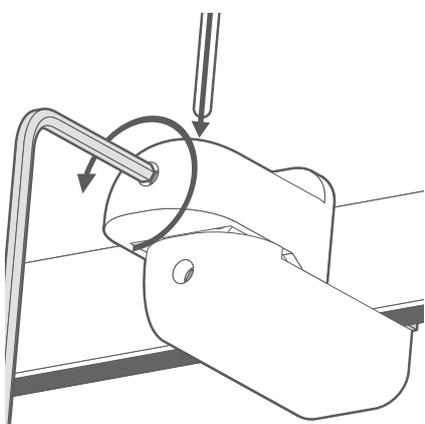
Usate la chiave a brugola per allentare la parte superiore della staffa in modo da poter inserire la cordicella.
