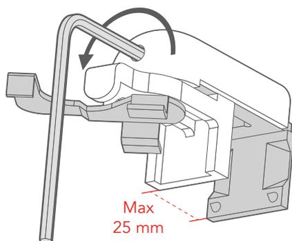
Utilizzate la chiave a brugola per allentare la staffa e apritela fino a un massimo di 25 mm.
