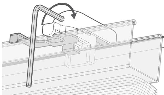
Una volta soddisfatti della posizione delle staffe, utilizzate la chiave a brugola per stringerle.
