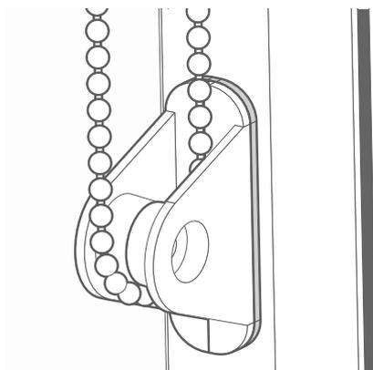
Infine, fissate la guida della catenella al telaio della finestra.
