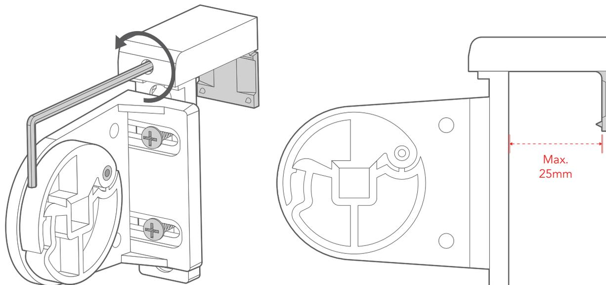
Utilizzate la chiave a brugola in dotazione per aprire la staffa. La staffa si apre fino a un massimo di 25 mm.
