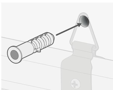
Usate una punta da trapano della stessa misura dei tasselli forniti, forate dove avete fatto i segni e inserite un tassello in ogni foro.
