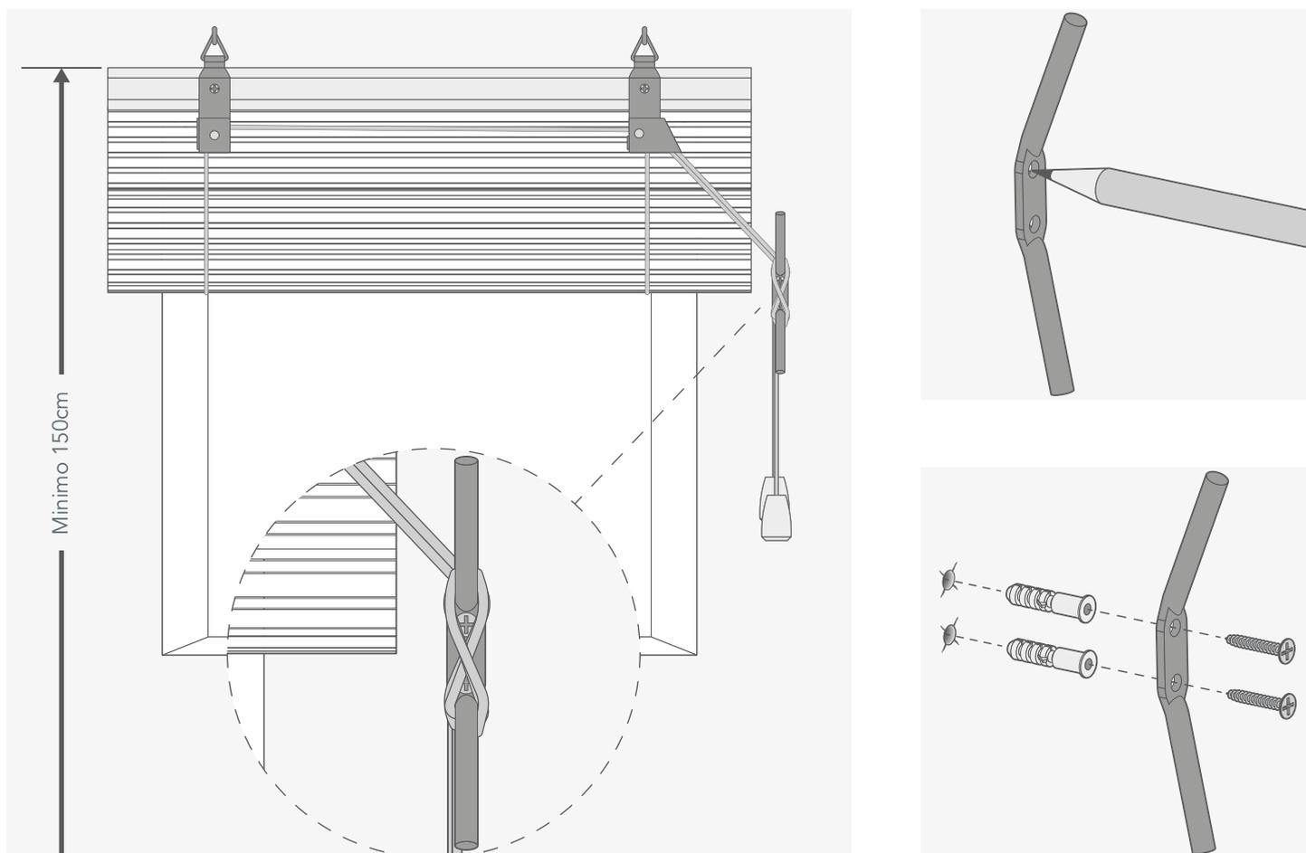
Posizionate il fermacorda dove volete installarlo e segnate i punti per i fori con una matita. Con una punta da trapano della stessa misura dei tasselli, forate nei punti segnati. Poi inserite i tasselli e fissate il fermacorda al muro con le viti fornite.
