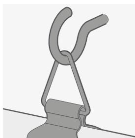
Potete installare i ganci in due modi: in alto sul soffitto del vano finestra oppure frontalmente sulla parete. Il fissaggio in alto è consigliato se montate la tenda dentro il vano. Se invece la montate sopra il vano finestra, sulla parete, fissate i ganci frontalmente.
